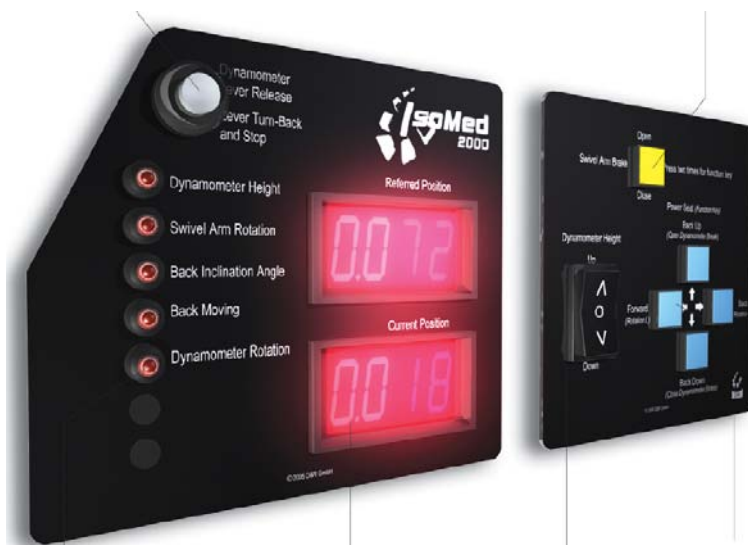
Obrázek 2. Display udávající aktuální pozici hlavy dynamometru a tlačítka k její změně
