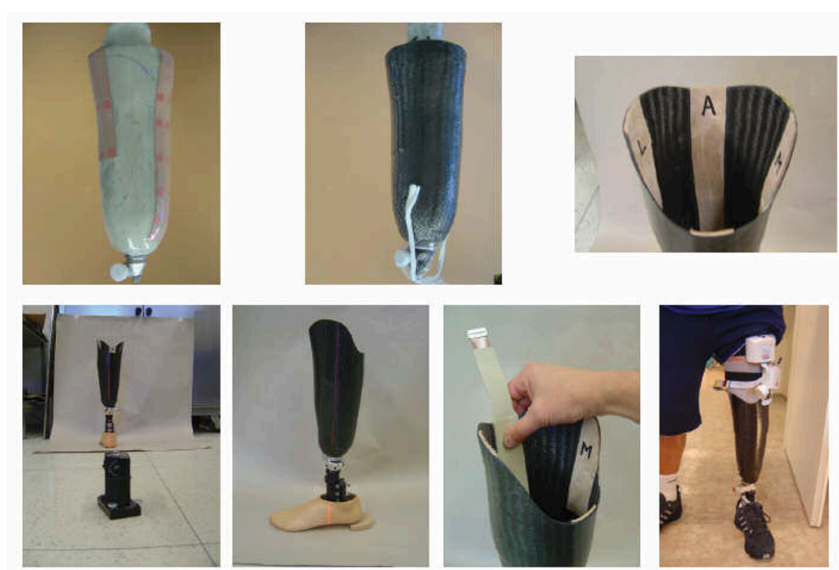
Obrázek 15 Příprava lůžka protézy pro měření tlaků
